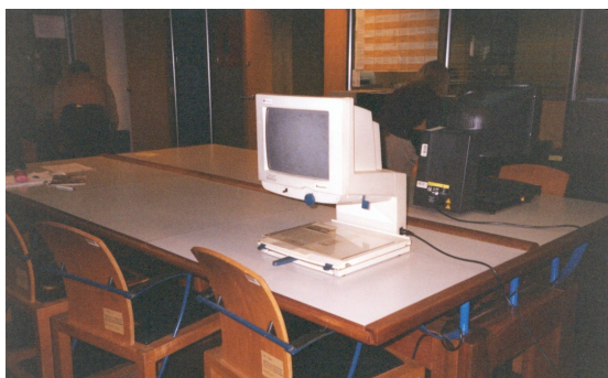
Figura 10. Dos puestos de trabajo confortables. A la izquierda se observa una telelupa para disminuidos visuales. A la derecha un lector de documentos impresos que traduce a Braille. En ambos casos el usuario dispone de mayor espacio para realizar sus consultas, incluso en grupos de dos o tres personas
